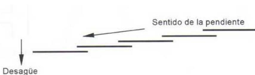
La soldadura entre los distintos paños de membranas se realizar con soplete de gas, con el que se calientan ambas superficies a soldar, lográndose la fusión total de ambos polietilenos de cobertura u la fusión de superficial de ambos asfaltos.
